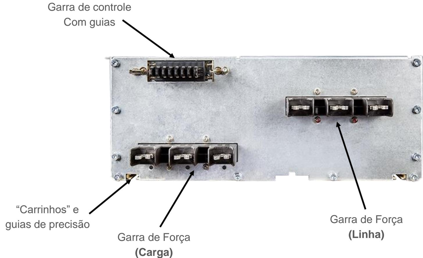
Sistemas desenvolvidos para movimentos de alta velocidade e precisos (CNC) permitem inserção e extração seguras (Evitam desalinhamento de garras e **previnem** ocorrências de **curtos-circuitos** e/ou **arcos elétricos**)
