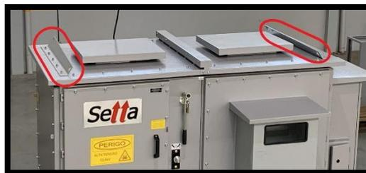
**Figura 10:** Cinta utilizada para içamento
