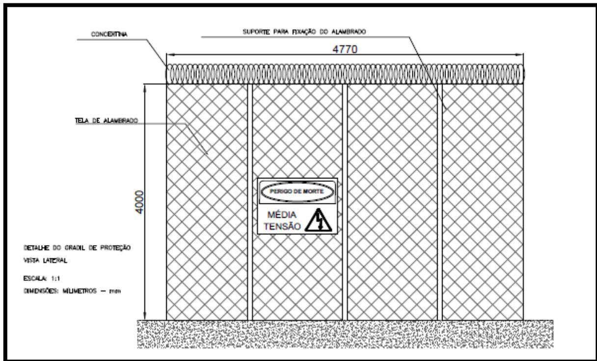
Figura 15: Alambração para proteção, vista lateral
